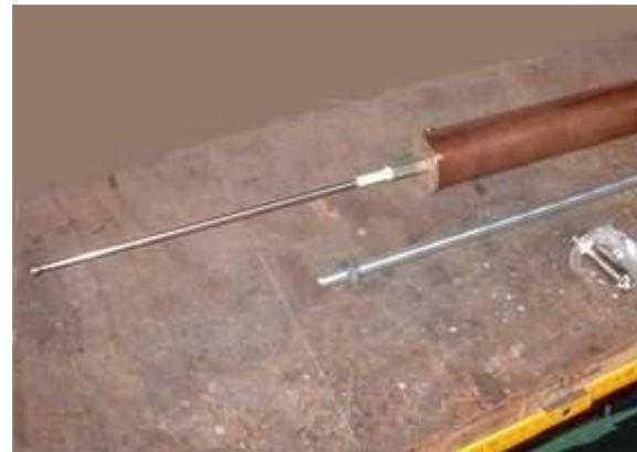
Zuerst wurde aus dem Kupferblech der Schleifer für die Spule zurechtgeschnitten und auf das Kupferrohr gewickelt. Die Windungen der Spule wurden mit Schmirgelpapier blank geschmirgelt.
