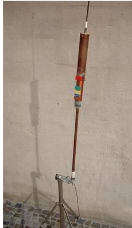
Der Antennenfuss wurde aus zwei Alu-Winkelstücken und einem Stück Flach-Alu, ähnlich dem Original, ersatzweise gefertigt.
