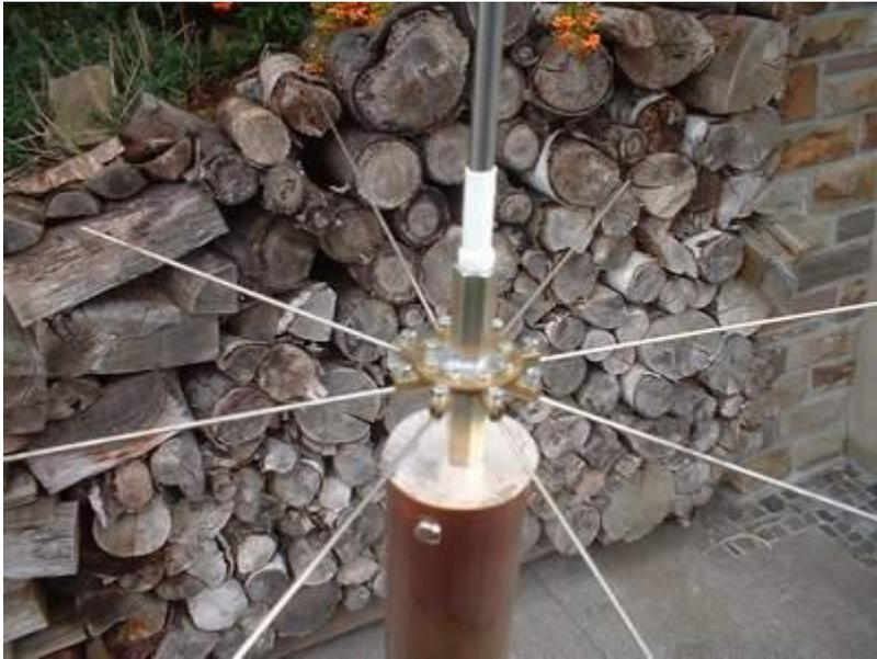
Durch eine zusätzliche Dachkapazität konnte ich die Arbeitsfrequenz bis auf das 40m-Band herunterdrücken. Leider nicht
